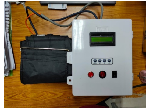
รูปที่ 2 เครื่องตรวจจับแรงกดแปลห้ามเลือก ควบคุมด้วยอาคูโน
