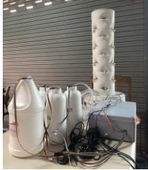
รูปที่ 1 ชุดควบคุมการปลูกเรคคอร์ดแบบแอโรโพนิคส์
