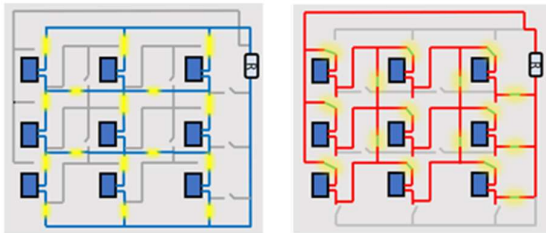
(a) ระบบเชื่อมต่อ TCT แบบ A รูปที่ 4 รูปแบบการเชื่อมต่อของวงจรหลังทำการสับสวิตช์ให้ระบบเชื่อมต่อแบบ TCT
