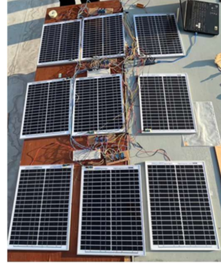
รูปที่ 1 ทดลองการสั่งให้สวิตช์ทำงานตามคำสั่งกับแผงเซลล์แสงอาทิตย์แผงจริง
