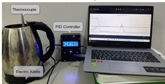
รูปที่ 4 การควบคุมอุณหภูมิของกาต้มน้ำไฟฟ้าในห้องปฏิบัติการจริง
