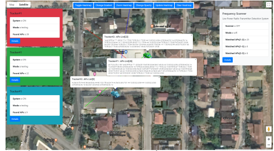
รูปที่ 7 หน้าจอแสดงผลการสแกนความถี่ access point ของรถแต่ละคัน
