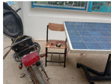
รูปที่ 7 มอเตอร์ไซค์ไฟฟ้าคันแบบที่ใช้ในการทดสอบชาร์จแบตเตอรี่จากพลังงานแสงอาทิตย์
